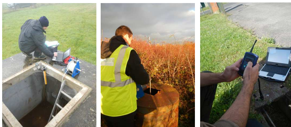
Figure 6 : La récupération des données au captage de Voinsles en novembre (à gauche), la mesure du niveau de la nappe au puits de Vert-Saint-Denis en novembre (au centre) et le test du signal GPRS sur le site d'Evry-Grégy-sur-Yerres en mai.
