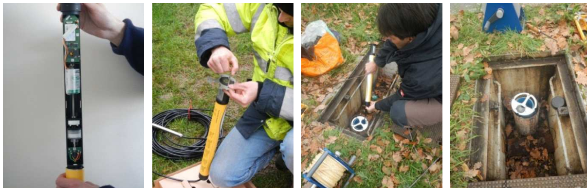
Figure 3 : L'appareil OTT Ecolog 500 et sa fixation dans le tube du forage/piézomètre.
