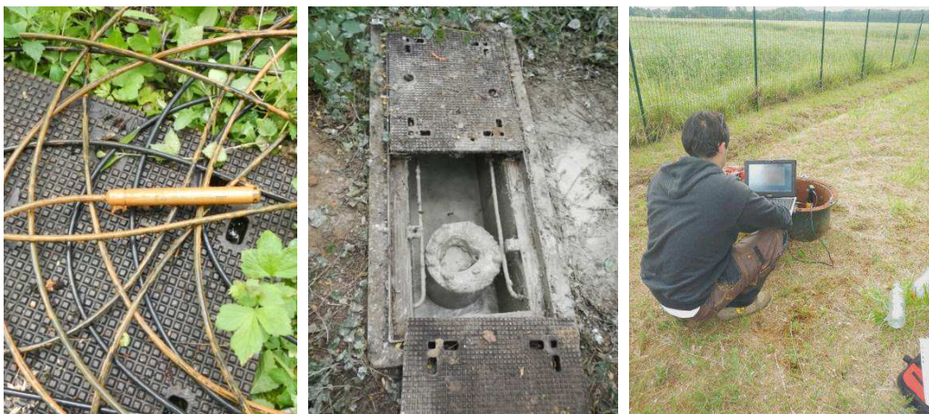
Figure 5 : La sonde de mesure recouverte de boue ferrugineuse en mai (à gauche), le forage/piézomètre de Pézarches rebouché par SANFOR en juin (au centre) et l'installation de l'appareil de mesure dans le captage de secours du SIAEP de Touquin par le technicien d'OTT en mai (à droite).
