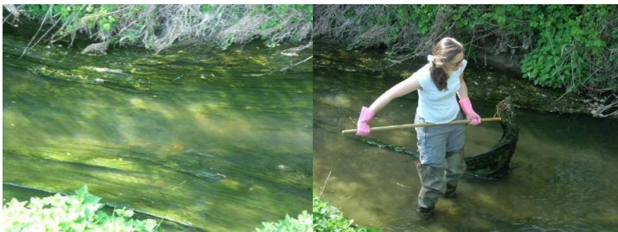
Photos 11 : Développement d'algues filamenteuses sur le ru d'Ancoeur à Saint-Ouen qu'il faut enlever pour effectuer les jaugeages au moulinet dans de bonnes conditions (elles bloquent l'hélice)
