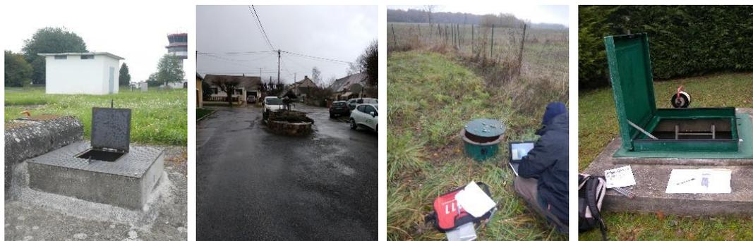
Figure 2 : de gauche à droite : les piézomètres de Montereau/Jard et St-Martin-Chennetron gérés par le BRGM, celui du CD77 à Cerneux géré par AQUI' Brie, et d'Eau du Sud Parisien à Marolles-en-Brie - Photos AQUI' Brie
