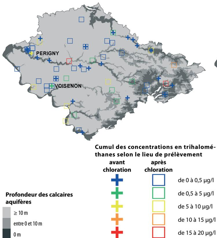
▼ Fig. 2 : détections d'Organo-Halogénés-Volatiles en 2000-2001
