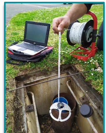
Contrôle du niveau de la nappe au piézomètre du CD77 d'Evry-Grégy/Yerres le 11 mai (50,86 m NGF)
