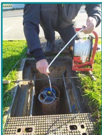
Contrôle de la mesure du niveau de la nappe au piézomètre du CD77 de Roissy-en-Brie le 8 novembre
