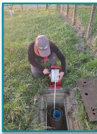
Mesure du niveau de la nappe au piézomètre du CD77 de Chevru le 9 novembre
