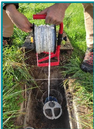
Mesure du niveau de la nappe au piézomètre du CD77 de Cerneux le 7 novembre
