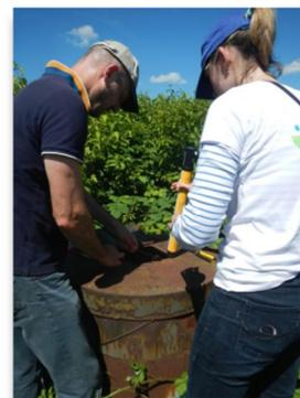
Figure 7 : Mise en place d'une station de mesure OTT Ecolog 800 à Vert-St-Denis, afin de suivre en plus du niveau, la conductivité de la nappe dans ce secteur.
