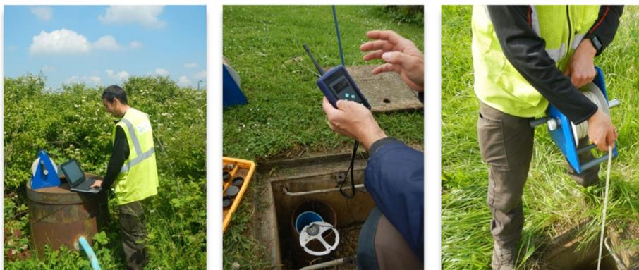
Figure 8 : Récupération des données (à gauche), test du signal GPRS (au centre) et mesure du niveau de la nappe à la sonde lumineuse (à droite).
