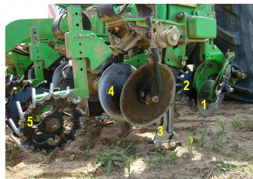
1 - disque ouvreur, 2 - chasse débris, 3 - dent droite à 2 angles, 4 - disques butteurs, 5 - roues squelettes pour rappuyer (source AQUI' Brie)
