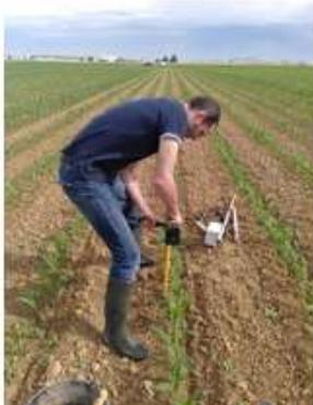
❖ Présentation par Ronan Olivo des sondes de mesures d'humidité des sols et de Net'Irrig
