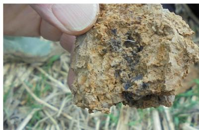
En rouille, les oxydes ferriques, en noires, les concrétions ferro-manganèse.
